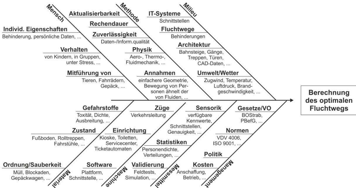
Abbildung 10.1: Ursache-Wirkungs-Diagramm zur Identifikation von Anforderungen an eine Methode zur Berechnung des optimalen Fluchtwegs aus einer U-Bahn-Station
