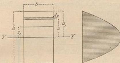
1) Für den rechteckigen Querschnitt (Fig. 116) liegt die wagrechte Schwerpunktsaxe in halber Höhe. Die wagrechte Schubspannung in der Höhe  $z_1$  über der Null-Linie ist nach Gleichung 89 zu bestimmen.
