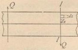
Hieraus folgt: In jedem lothrechten Querschnitte wirken lothrechte Schubspannungen, deren Summe genau gleich der Querkraft ist, welche sich für diesen Querschnitt ergibt.
