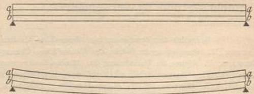
Für die rechnermässige Ermittlung dieser Schubspannungen möge, wie oben, angenommen werden, dass nur senkrecht zur Balkenaxe gerichtete Kräfte
