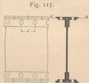
Wieder ist  $H = \frac{QS}{\mathcal{F}}$ , worin  $S$  das statische Moment der Lamellenfläche bezogen auf die Null-Linie bezeichnet. Nennt man den Abstand der Nietbolzen  $e$ , so ist die Gesamtschubspannung auf die Länge  $e$  gleich
