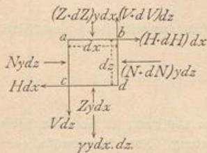
Die Vertheilung dieser Schubspannungen über den Querschnitt findet nach folgendem Gesetze statt: Die an irgend einer Stelle für die Längeneinheit wirkende lothrechte Schubspannung ist gleich der an derselben Stelle für die Längeneinheit wirkenden wagrechten Schubspannung.
