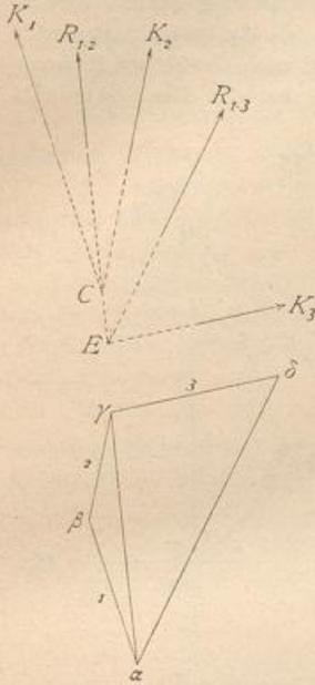
Denn man kann (Fig. 13) zunächst die beiden Kräfte  $K_1$  und  $K_2$  auf ihren Richtungslinien beliebig verschoben, also auch bis zu dem Schnittpunkte  $C$  derselben. Für die beiden im Punkte  $C$  angreifenden Kräfte liegt nun die Aufgabe genau so, wie oben entwickelt ist. Ist  $K_1 = \alpha\beta$  und  $K_2 = \beta\gamma$ , so ist  $\alpha\gamma$  die Mittelkraft  $R_{1-2}$  von  $K_1$  und  $K_2$ .
