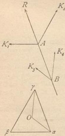
Wie man die GröÙe und Richtung der Mittelkraft zweier Kräfte  $K_1$  und  $K_2$  in der dritten Seite  $\alpha\gamma$  (Fig. 14) des für die beiden Kräfte construirten Kraftpolygons  $\alpha\beta\gamma$ , hier der Schlußseite des Kraftdreieckes, findet, so kann man auch irgend eine gegebene Kraft  $R$  als Mittelkraft zweier Kräfte  $K_1$  und  $K_2$  auffassen. Diese beiden Kräfte müssen nur zwei Bedingungen genügen, und zwar:
