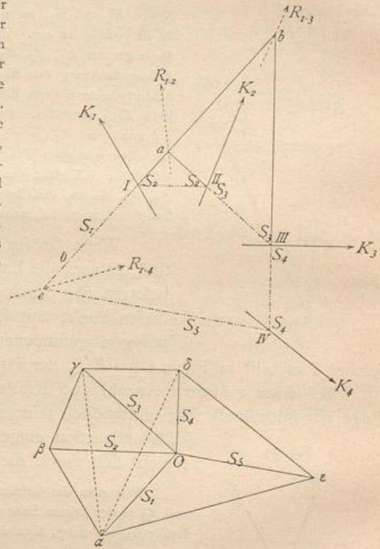
Denn die in den mittleren Seilpolygonseiten wirkenden Kräfte heben sich sämtlich gegenseitig auf, und es bleiben nur die in den äußeren Seilpolygonseiten wirkenden Kräfte übrig, deren Mittelkraft mit derjenigen der gegebenen Kräfte in jeder Beziehung übereinstimmt<sup>2)</sup>.
