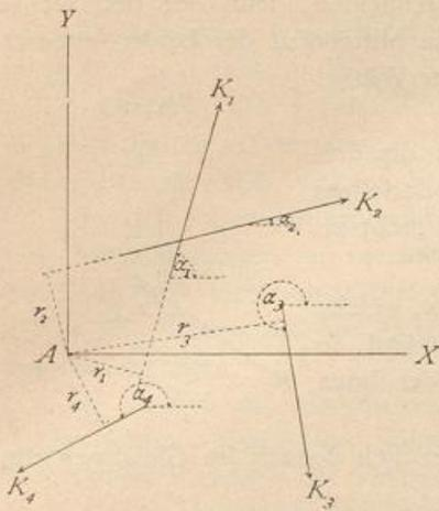
Man zerlege demnach sämtliche Kräfte ( $K_1, K_2, K_3 \dots$  in Fig. 4) nach zwei zu einander senkrechten Richtungen, von denen die eine ganz willkürlich angenommen werden kann. Alsdann erhält man als Gleichgewichtsbedingungen für die sämtlichen Kräfte die Gleichungen:
