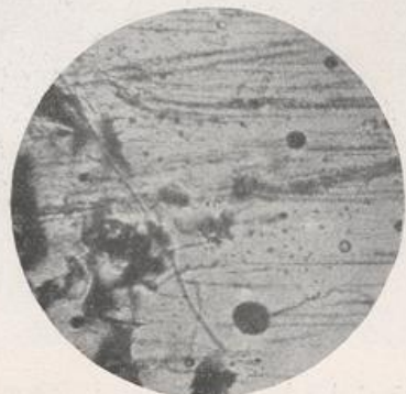
Fig. 33. Selenplatte. Umwandlung von Selen A in Selen B längs mechanischer Kratzer. Nach Marc: „Die phys.- chem. Eigenschaften des met. Selens“. Hamburg 1907.
