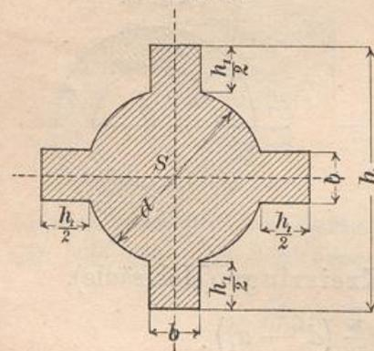
70) Querschnitt der Flügelachse und der Säule mit Verstärkungsrippen.
