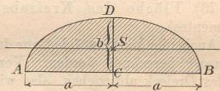
Zweite Form. Für  $AB$  ist  $T' = \frac{a b^3 \pi}{8}$ , nach Nr. 12) ist  $h_s = \frac{4b}{3\pi}$ , also folgt für die horizontale Schwerpunktsachse
