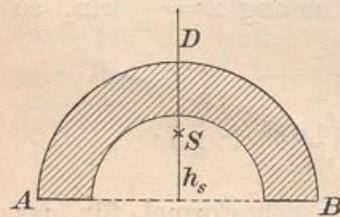
Nach Nr. 6) ist  $h_s = \frac{4(r^3 - r_1^3)}{3\pi(r^2 - r_1^2)}$ , außerdem für  $AB$
