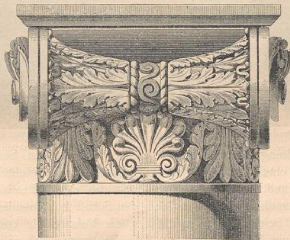
Vorder- und Seitenansicht eines römisch-jonischen Säulenkapitells 43) .
