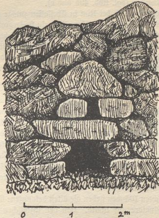
Abb. 46. Entlastungsdreieck über einem Nymphaeum-Eingang. Nach E. Hoffmann.
