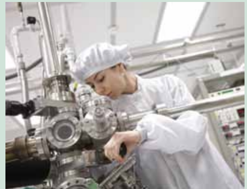
Molekularstrahlepitaxie zur Herstellung optoelektronischer Halbleiter
