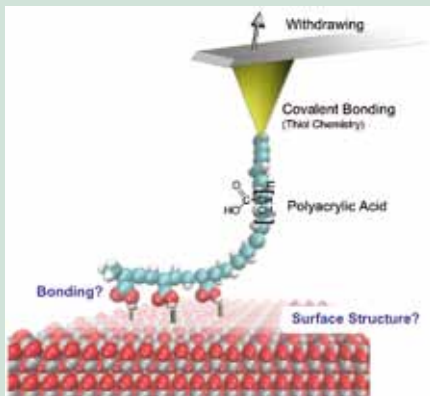
Schematisches Funktionsprinzip der Einzelmolekülkraftspektroskopie zur Analyse lokaler Adhäsion.
