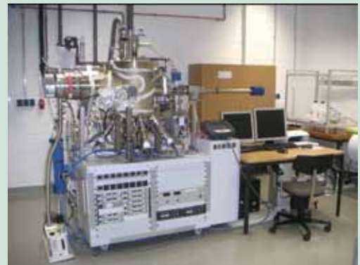
Anlage zur Molekularstrahlepitaxie von Zinkoxid
