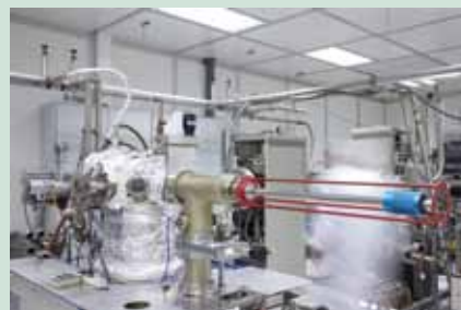
MBE-Anlage für Nitride
