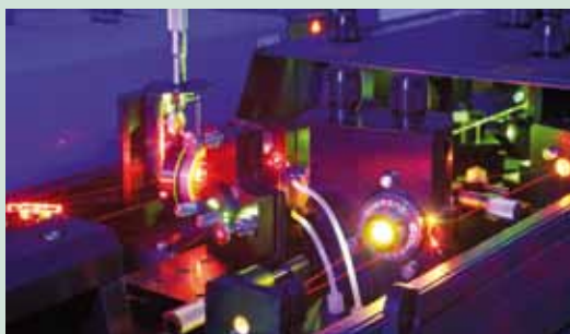
Durchstimmbarer ps-Laser für die kohärente Spektroskopie
