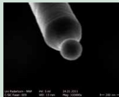
Siliziumkarbid-Nanokugel auf Siliziumkarbid-nanodraht
