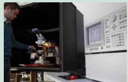
Spitzenmessplatz für elektrische Charakterisierung
