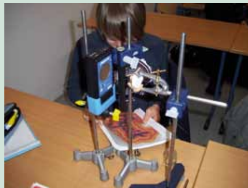
Interesse fördernder Unterricht: Füllstandsmessung mit Isotopenmesstechnik
