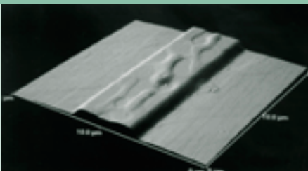
Oben: Integrierter Streifen-Lichtleiter in Lithiumniobat (Aufnahme mit Atomkraftmikroskop)
