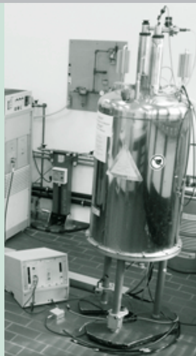
Supraleitender Magnet (rechts) des NMR-Spektrometers (Bruker MSL 300) mit Vorverstärker und High-Power-Schrank
