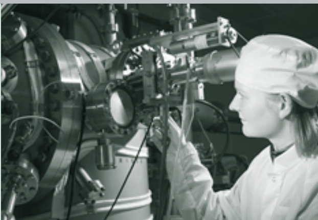
Kontrolle des MBE-Wachstums einer kubische GaN Schicht
