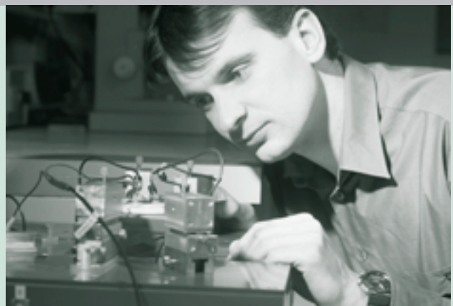
Testen der elektrischen Eigenschaften kubischer GaN LEDs
