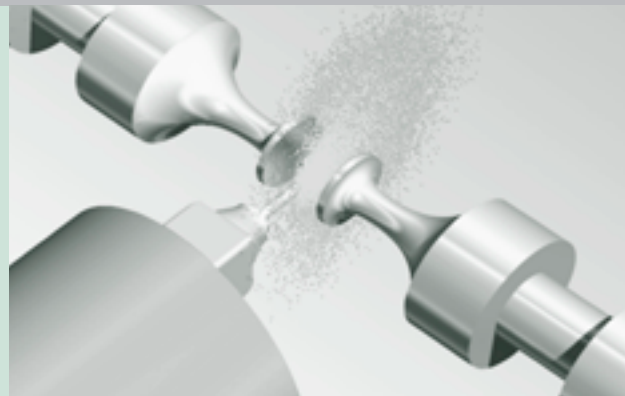
Zerstäuben von Pulverlack im Ultraschallstehwellenfeld
