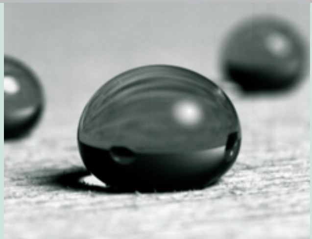
Wassertropfen auf einer mit Nanopartikeln behandelten Holzoberfläche; technisches Produkt der BASF, welches den „Lotus-Effekt“ nachstellt (Foto: BASF)
