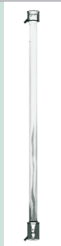
2-Phasen-Strömung im Blasenströmungsreaktor
