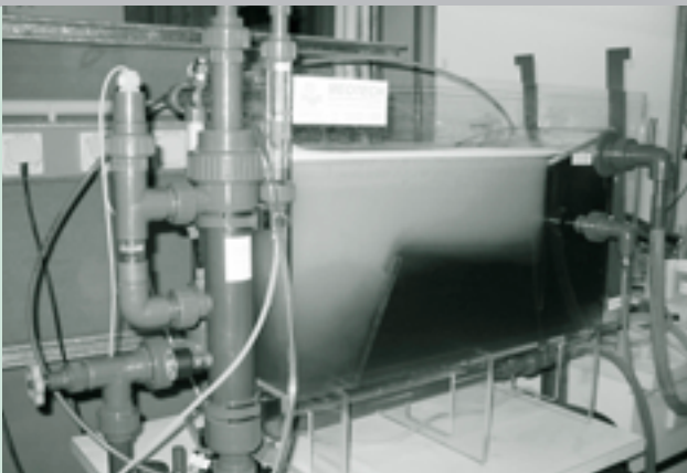
Versuchs-Flotationsanlage nach dem Druckentspannungsprinzip
