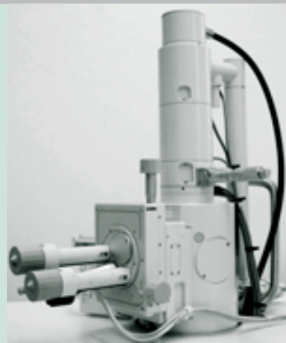
Rasterelektronenmikroskop zum Herstellen und Betrachten von Nanostrukturen
