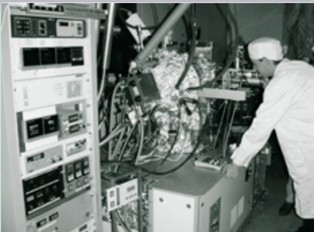
Herstellung von Halbleiterschichten im Ultra-Hochvakuum (Molekularstrahlepitaxie)
