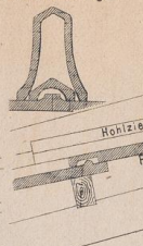
Fig. 4 Querschnitt der Hohl-Reiter u. Firstziegel.
