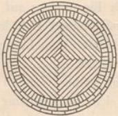
Abb. 67. Wölben. Die Einwölbung des Nabels einer Kuppel in Backstein geschicht auf Schwalbenschwanz, um zu kleine Wölbstücke, die gehauen werden müßten, zu vermeiden.
