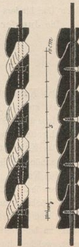
Abb. 2. Jalousie. Profile der Stäbe in Abb. 1 (unter Musterschutz); links Schnitt durch die Schlütze, rechts Schnitt durch die vollen Stäbe (Frieße).
