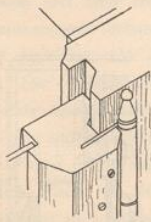
Abb. 10. Fenster. Verschiedene (Kneif-) Falzformen für das seitliche Ineinandergreifen der Flügel und Blendrahmen.
