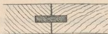
Abb. 1. Feder, wie sie als Holzleiste in die genutheten Bretter eingeschoben ist zur Verbindung durch „Nuth und Feder“; stets muß die Maserung der Feder schräg zur Längsrichtung, nicht mit dieser gleich laufen, damit die Feder nicht der Länge nach durchbricht.
