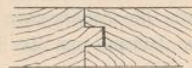
Abb. 2. Feder bei der Verbindung durch „Nuth und Feder“, wenn diese Benennung fälschlich für Spundung gebraucht wird, wie es allgemein geschieht.
