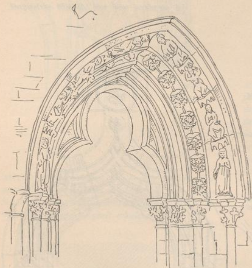
Abb. 13. Gotischer Portalbogen am Dome zu Minden; das Thürlicht ist von einem Kleeblattbogen oben abgeschlossen, der hier kein Tympanon enthält. In Spitzbogen folgt Stabwerk, eine Kehle mit schönem Blattwerk und zuletzt noch eine Kehle mit kleinen Statuen, welche die klugen und thörichten Jungfrauen darstellen.
