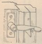
Abb. 9. Beschlag. Einfacher oder halber Vorreiber, zum Verschluss des Fensterflügels dienend. Durch das Streicheisen s wird der Flügel fest angedrückt und das Holz an der Verschlussstelle geschont.
