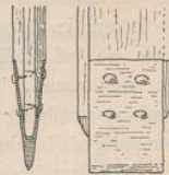
Abb. 11. Baugrube. Spundbohle mit Eisenschuh für festen, steinigen Boden.
