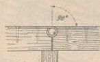
Abb. 53. Nicht vortheilhafte Anordnung des Gelenkbandes. Die Thür ist nur um einen Winkel von 90 Grad drehbar, bei weiterem Öffnen springen die Bänder ab.
