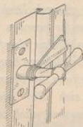
Abb. 10. Beschlag. Halber Vorreiber mit Olive oder Drehknäuf zu demselben Zwecke wie Abb. 9.
