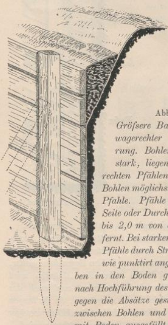
Abb. 1. Baugrubenwand mit Böschung bei mittelmäßig festem, nicht lothrecht stehendem Boden.
