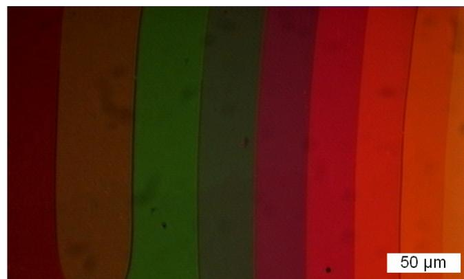
**Abb. 5.49:** Textur der Kontaktzelle unter gekreuzten Polarisatoren im Bereich mittlerer Ganghöhen. Die Ganghöhe sinkt von links nach rechts, ebenso wie die Breite der Domänen mit gleicher Ganghöhe.
