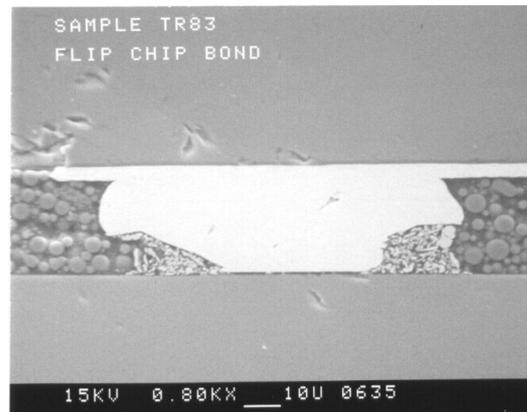
Abbildung 21: Schliff einer Flipchip-Verbindung
