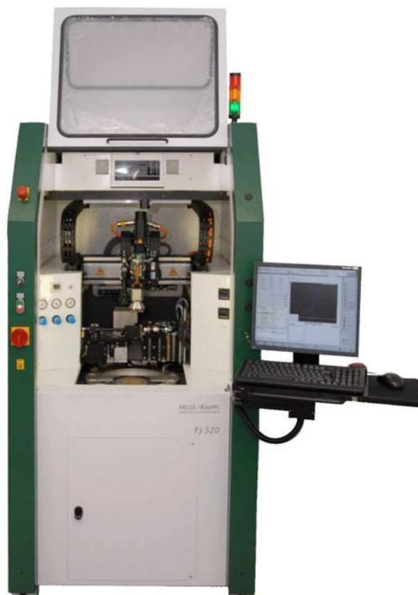
Abbildung 50: Der US-Flipchip-Bonder FJ520 der Hesse & Knipps GmbH [36]
