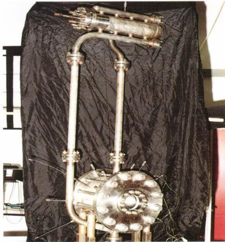
Photographische Aufnahme des Schwerkraftkreislaufes, bestehend aus Verdampfer (unten) und Kondensator (oben) für Wärmeübergangsmessungen beim Sieden in einem großen Druckbereich
