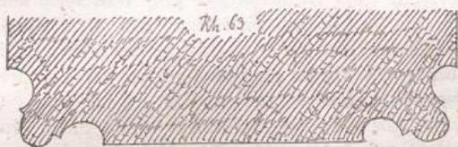
unterstützt wird. Die Bögen von Pfeiler zu Pfeiler halbrund, wie die unteren Bögen, an den Ecken mit Rundstab und Kehlen profilirt (Rh. 63.). Auch die Fenster rundbogig, mit in gothischer Weise ge-
