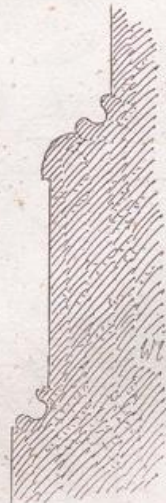
Basament der nördlichen Schiffpfeiler.
