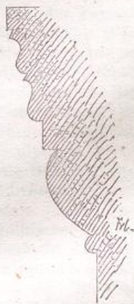
Kapitälgesimse der Schiffpfeiler.
