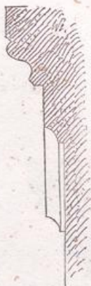
Profil des Dachgesimses am südl. Flügel des Querschiffes, östl. Seite.
