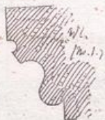
Profil der Deckgesimse, 1.
