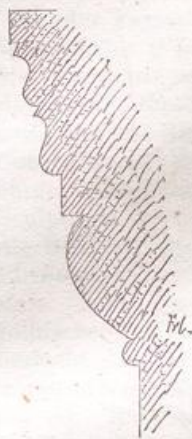
Kapitälgesimse der Schiffpfeiler.
