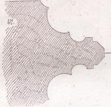
Fensterprofil im nördlichen Seitenschiff.
