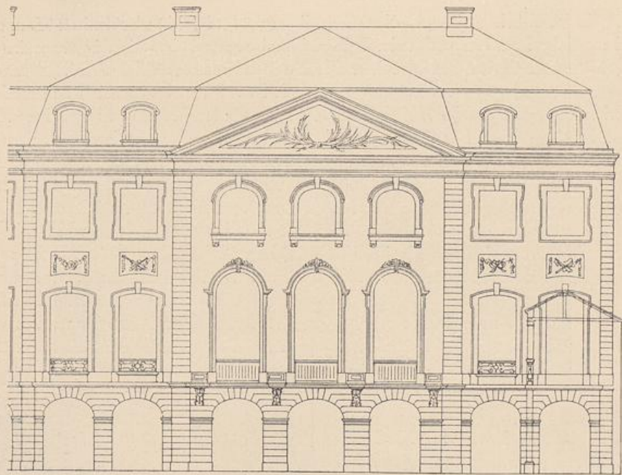
Abb. 176. Aachen. Originalentwurf von Jacob Couven für die alte Kurhaus-Rückfront. Vgl. Abb. 177—180 und 192. Bei der Ausführung wurden die Arkaden der Hoffront geschlossen.
