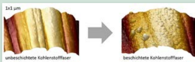
AFM-Aufnahme von einer unbeschichteten Kohlenstofffaser und einer Kohlenstofffaser, die mit einem Polymer beschichtet wurde
