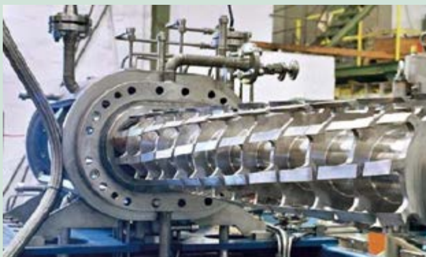
Hochviskose Prozesse in Knetern: Mischwerkzeug eines Kneters
