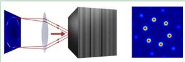
Schematische Darstellung eines Quantenfilm Mikroresonators (li.). Spontane Musterbildung in der kohärenten Fernfeldemission im nichtlinearen Regime (re.). Externe Kontrolle der Muster kann für opto-optische Schaltmechanismen verwendet werden.
