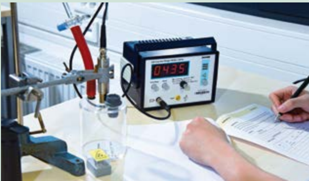
Schülerinnen und Schüler messen die Strahlungsintensität eines radioaktiven Strahlers
