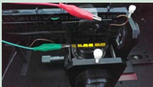
Apparatur zur Untersuchung organischer Leuchtdioden (Foto: Joachim Vollbrecht)
