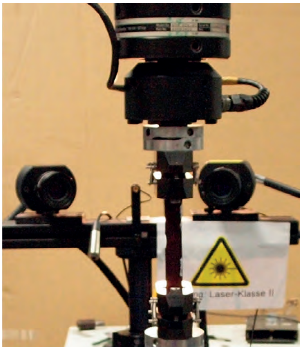
Abb.: links: Elastomer im Zugversuch und optisches Messsystem, rechts: Vergleich von Experiment und Simulation
