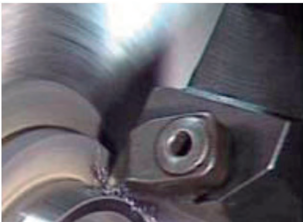
Abb: links: Hochpräzisions Hartdrehen (Quelle: IWF,TU Berlin),rechts: Zerspansimulation(Spannungsmodedefaktor)
