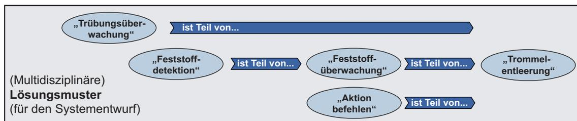
Bild 5-6: Aggregation des multidisziplinären Lösungsmusterkandidaten „Trommelentleerung“
