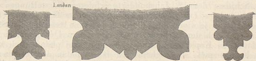
Aus dem Rundbau der Templerkirche zu London. Profil des Scheidbogens und zweier Kreuzgürte des Umgangs. (Nach Billings.)
