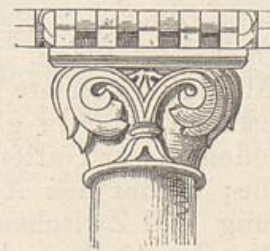
St. Etienne zu Caen. Kapitäl der Gurtträger des Gewölbes. (Nach Osten.)
